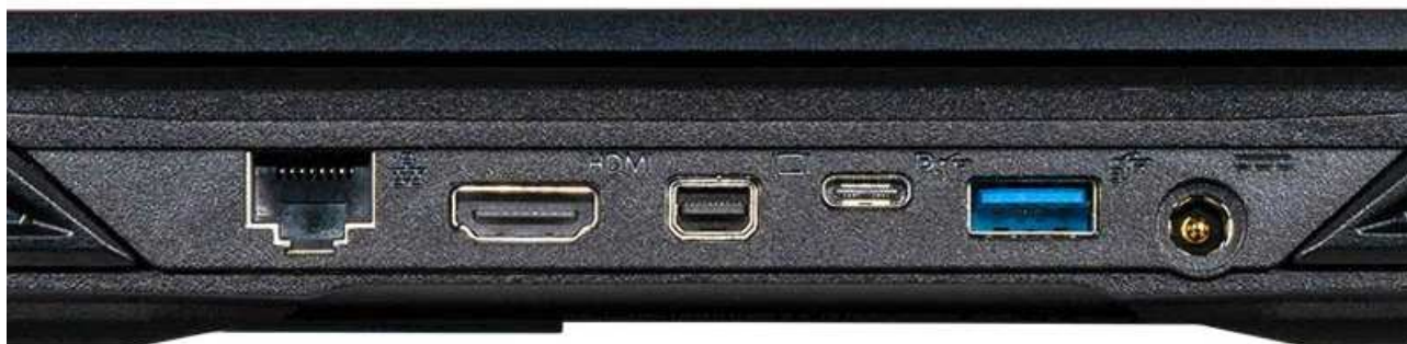
背面ポート画像：左から、有線 LAN/HDMI/Mini DisplayPort/USB3.1 Type-C/USB3.0 Type-A/電源の各ポート
