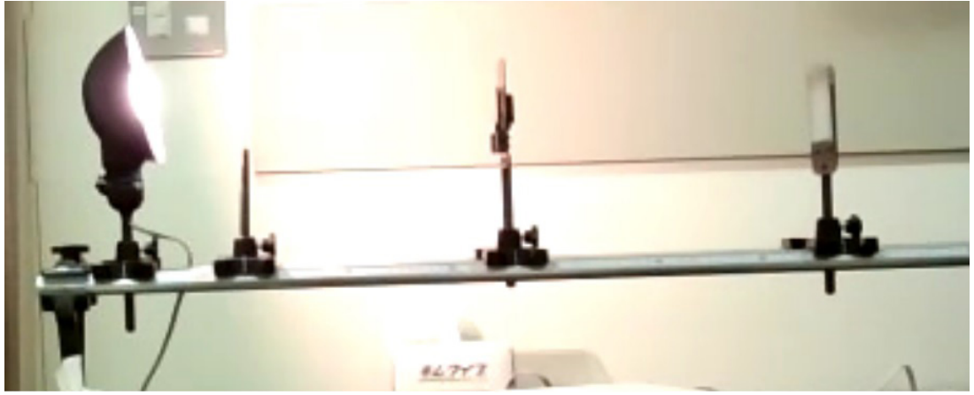
図1 通常の Web カメラで撮影した凸レンズの実験の画面。70cm の水平方向の広がり収めている。見せたい部分を強調するには、別カットでの撮影や編集が必要になる
