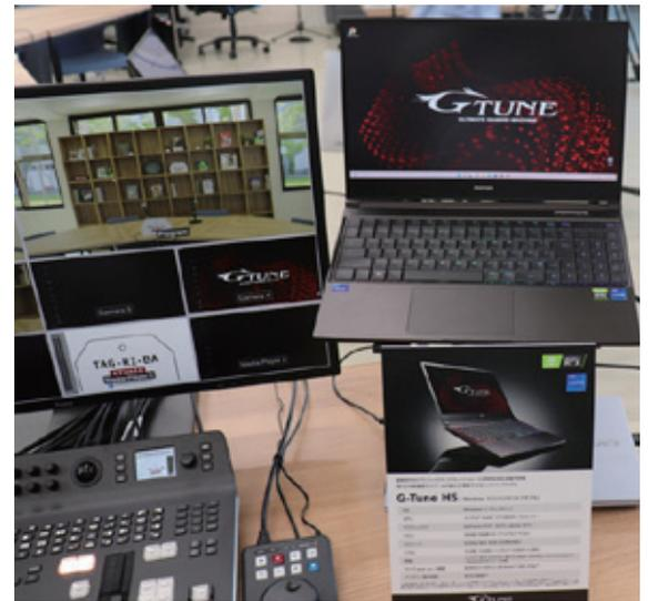
配信設備として設置した「G-Tune H5」は、CPUにインテル Core i7-11800H、GPUにGeForce RTX 3070 Laptop GPU/インテルUHDグラフィックスを搭載する最新世代のノートPC
