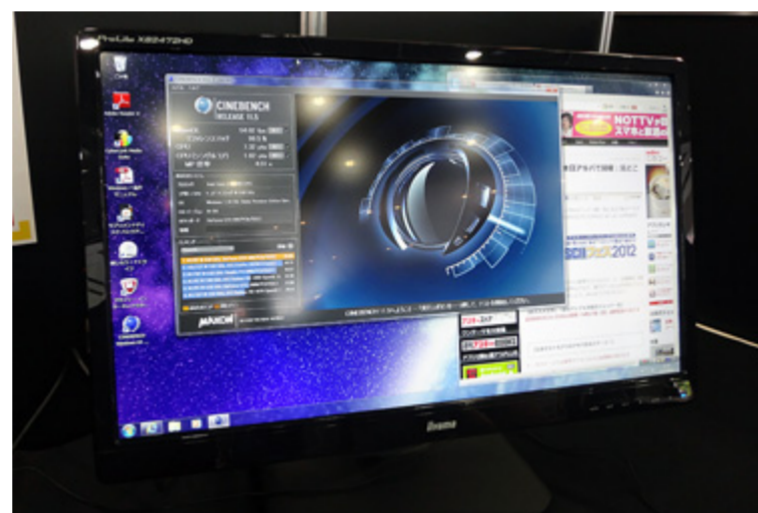
iiyama ProLite XB2472HD。広視野角VA方式パネル搭載で美しい色表現が可能に。
